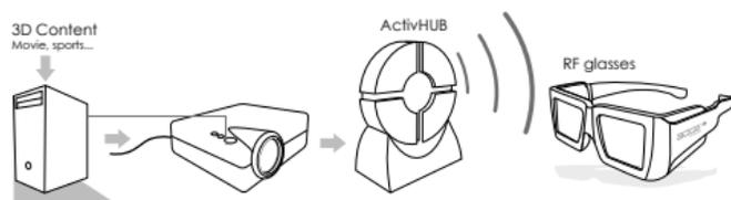
**L'ActivHub™ RF50 peut transmettre une synchronisation RF lorsqu'il reçoit un signal IR 3D.**
