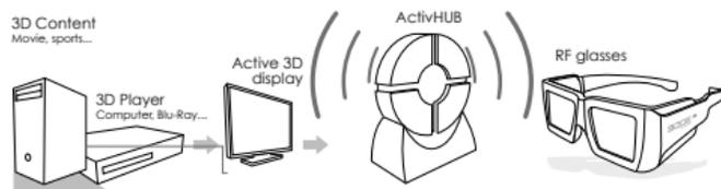
**L'ActivHub™ RF peut transmettre une synchronisation RF lorsqu'il reçoit un signal 3D DLP-Link™.**
